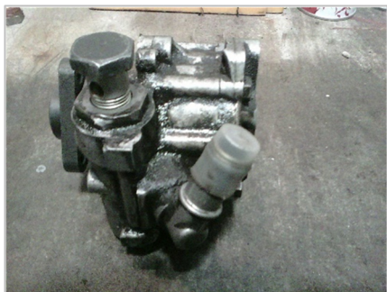
Рисунок 1. Масляный насос, изготовленный ООО "Рулевые системы". Сверху виден банджо-болт
