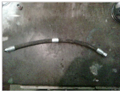
Рисунок 3. Второй (считая от масляного насоса) шланг высокого давления, изготовленный "РВД-эксперт". В центре шланга видна дроссельная вставка
