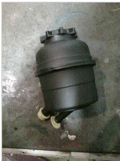
Рисунок 4. Масляный бачок-аналог бачка фирмы ZF. производитель ООО "Курганспецмаш"
