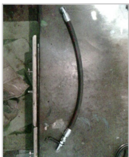
Рисунок 2. Первый (считая от масляного насоса) шланг высокого давления, изготовленный "РВД-эксперт"
