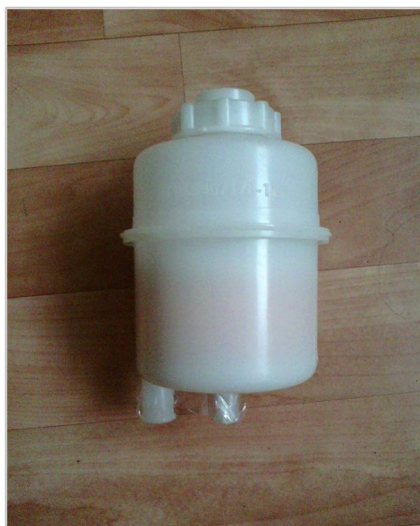
Рисунок 5. Полупрозрачный масляный бачок неизвестного российского производителя. Применяется на автомобилях "ГАЗ"
